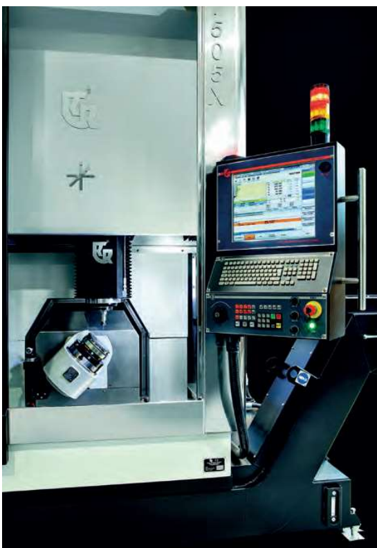
Centro di lavoro a 5 assi ad alta velocità EM 750-5X Linear, equipaggiato con motori lineari e torque per gli assi rotativi.
